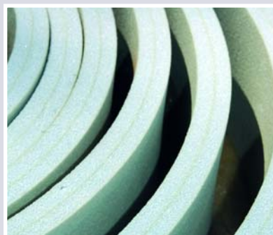
Дополнительная теплоизоляция (вспененный полиэтилен)
